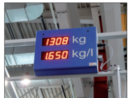
Dichte- und Gewichtsanzeige Display: density and weight
