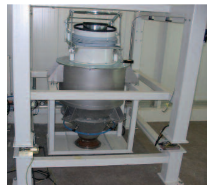
Big-Bag-Station als subtraktive Waage Big bag station as subtractive scales
