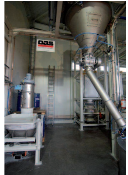
Handschütte und Empfangsbehälter über Dissolver Hand chute and receiving container above dissolver
