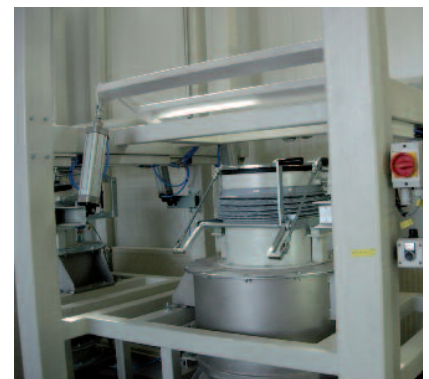
Staubarmer Anschluss und Walkvorrichtung Low-dust connection and tumbling unit
